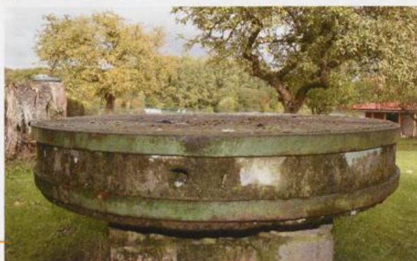
Abb. 23.6 Mühlenstein aus Heistermann Mühle. Er wurde regelmäßig geschärft, jede einzelne Rille, damit alle Körner erfasst und gemahlen wurden (Foto: A. Heuwinkel-Otter).
